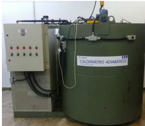
Figura 6.2 – Calorímetro adiabático desenvolvido no projeto P&D de Furnas- Modelagem de concreto em poucas idades com aplicações para barragens: novos paradigmas e suas soluções (Gambale et al., 2018).
