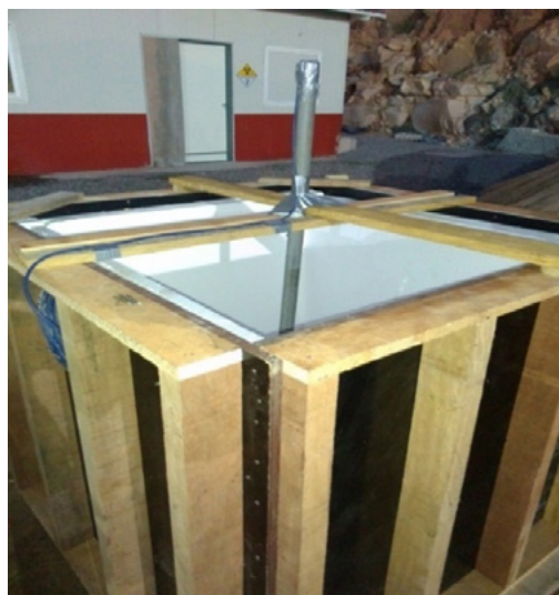
Figura 6.5 – Bloco preparado para ser monitorado por um termômetro instalado internamente. Fonte: Gambale et al., 2018.
