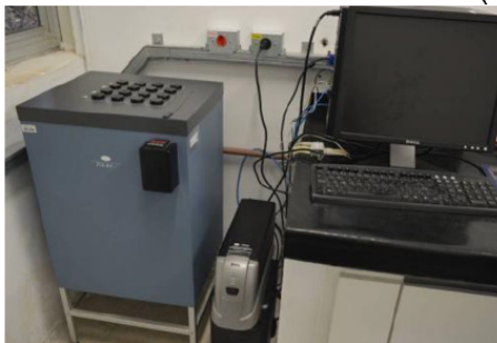
Figura 6.3 – (a) Curvas de calor de hidratação acumulado determinado por calorímetro isotérmico e amostras de cimento CPV com adição de diferentes teores de escória, e temperatura de ensaio igual a 23 °C; (b) Calorímetro isotérmico de condução e (c) ampola de vidro com volume de 25 mL.
