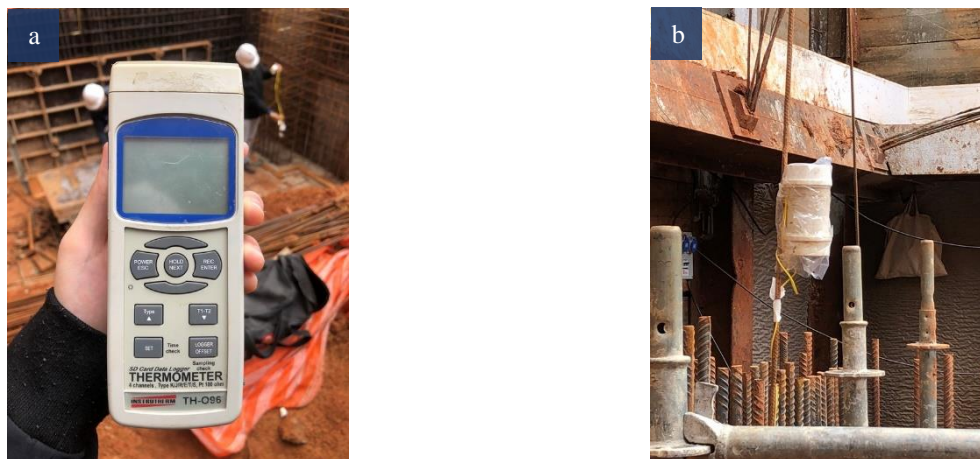
Figura 5 – (a) Data logger utilizado para armazenamento dos dados monitorados e (b) proteção do equipamento contra intempéries. Expansão do Colégio Bandeirantes (Deseq, 2021)
