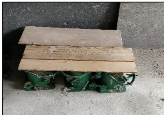
Figura 3 – Corpos de prova protegidos conforme ABNT NBR 5738 ( ABNT )
