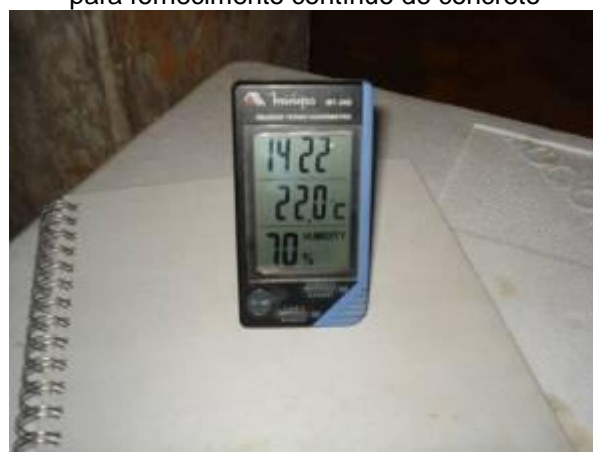
Figura 19. Equipamento utilizado para medição da temperatura ambiente e umidade relativa do ar
