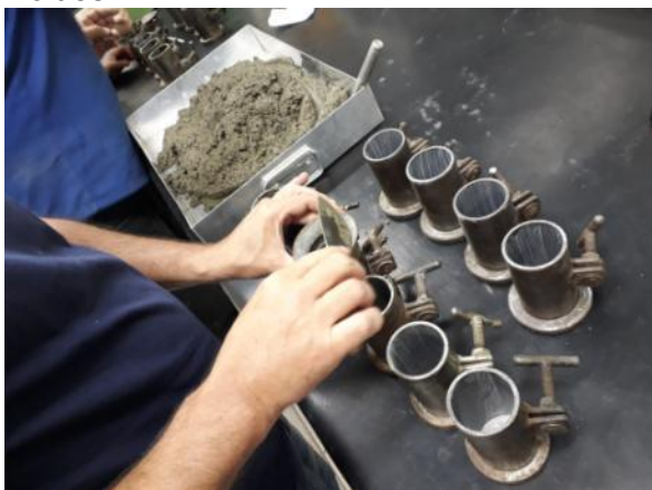
Foto 80 – Colocação da argamassa nos moldes
