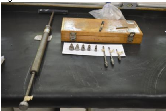
Foto 72 - Conjunto de agulhas de Proctor utilizado para realização dos ensaios em argamassa
