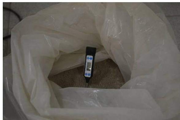
Foto 61 – Determinação da temperatura dos materiais secos
