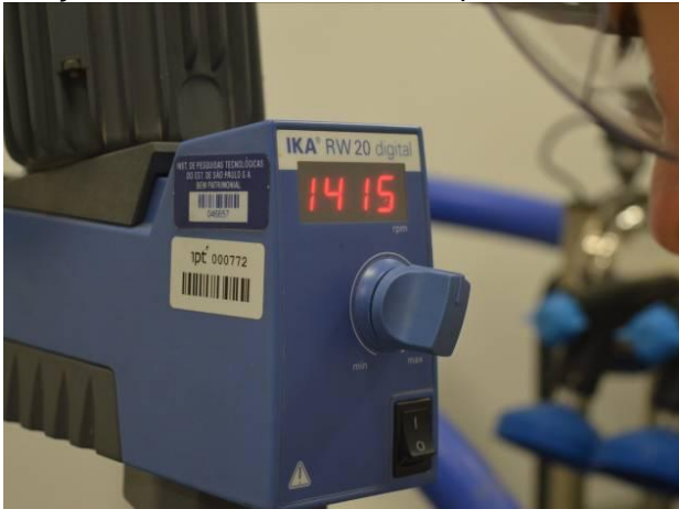
Foto 11 – Ilustração da velocidade de rotação do misturador de 1415 rpm.
