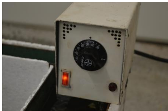
Foto 59 – Detalhe do termostato ou regulador de temperatura do banho térmico
