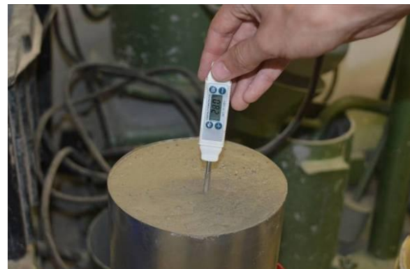
Foto 49 – Determinação da temperatura da argamassa recém-preparada
