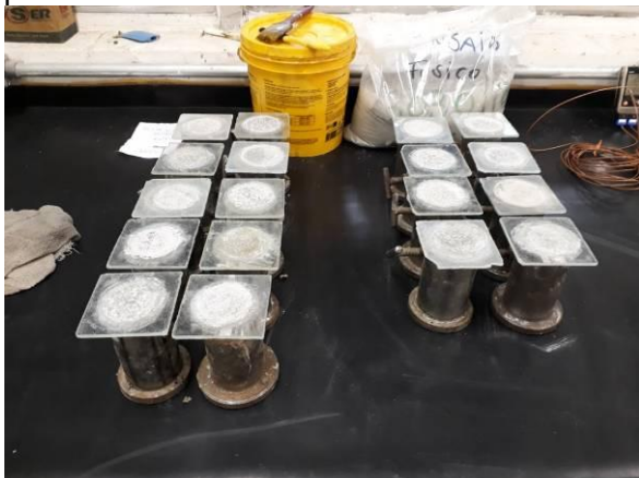
Foto 84 – Tamponamento dos corpos-de-prova moldados com placa de vidro para minimizar a evaporação de água nas primeiras horas
