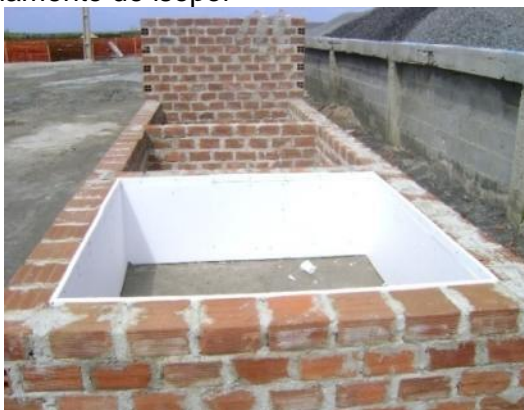
Figura 2 – Sistema em alvenaria para determinação prática da elevação de temperatura em concreto em obra com isolamento de isopor
