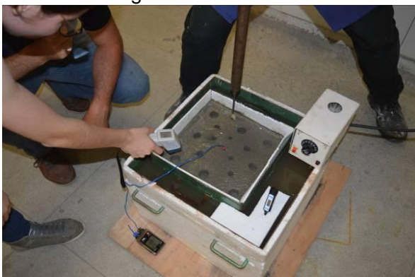
Foto 74 – Determinação da temperatura superficial da amostra através de termômetro digital
