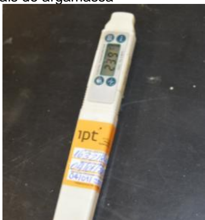
Foto 38 – Termômetro utilizado para determinação das temperaturas dos materiais de argamassa
