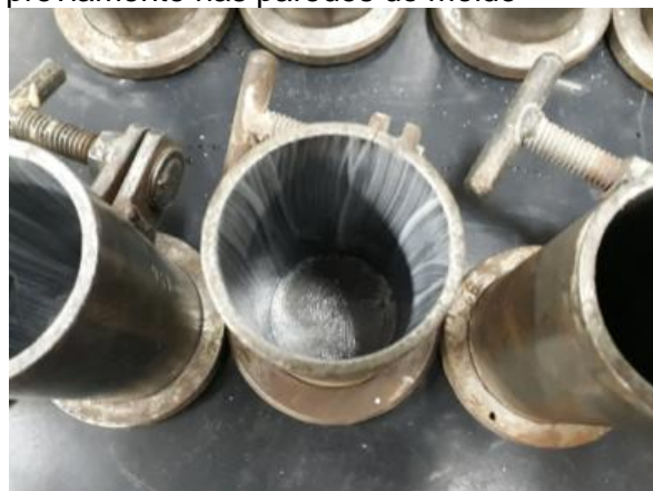
Foto 79 – Detalhe do desmoldante aplicado previamente nas paredes do molde
