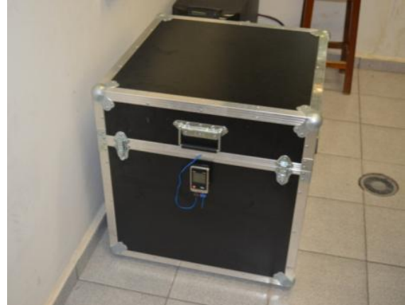
Foto 36 – Ensaio de calibração em andamento, com o HeatBox devidamente fechado
