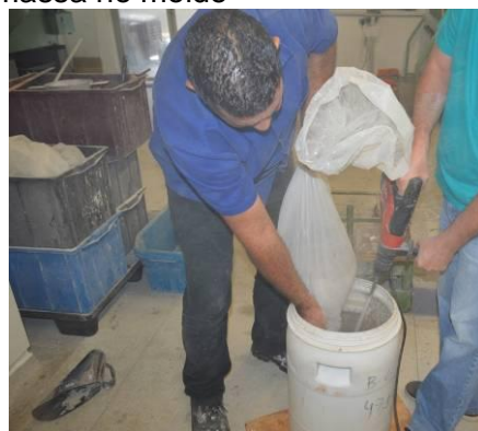
Foto 67 – Mistura dos materiais em balde plástico previamente a colocação da argamassa no molde
