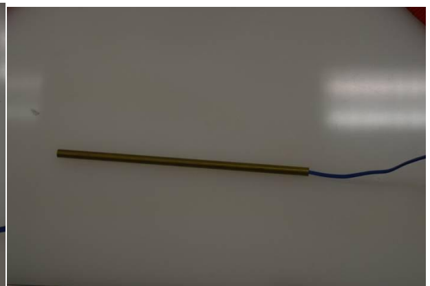
Foto 32 – Detalhe do termopar tipo "J" acoplado no tubo de cobre de proteção, a ser inserido no molde metálico.
