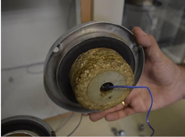
Foto 19 – Detalhe do isolamento da garrafa de Langavant fixado no sistema de fechamento.
