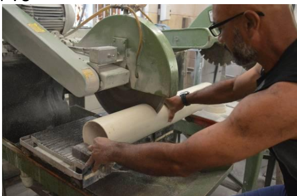
Foto 25 – Confeção de molde com tubo de PVC
