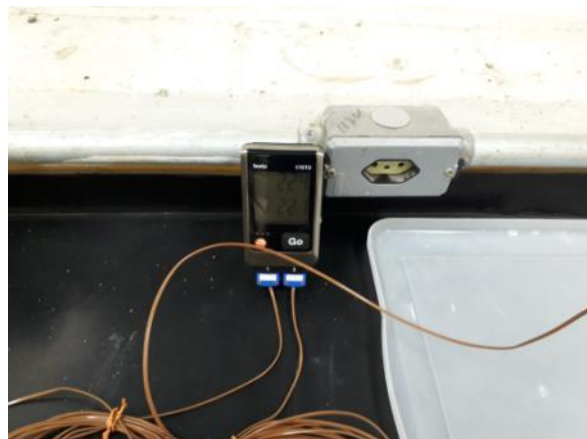
Foto 83 – Registro das temperaturas através de datalogger com intervalo de 40 s
