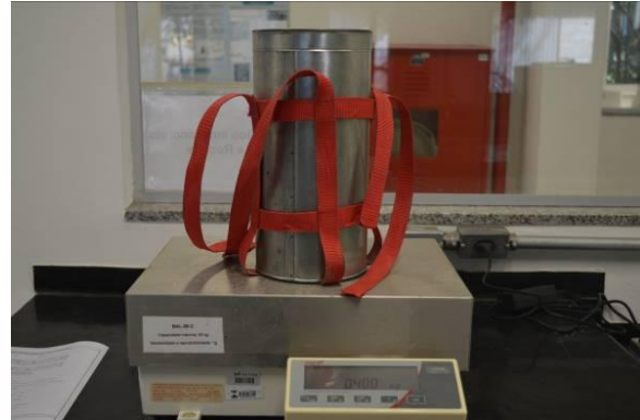
Foto 30 – Determinação da massa de água empregada na calibração do molde metálico
