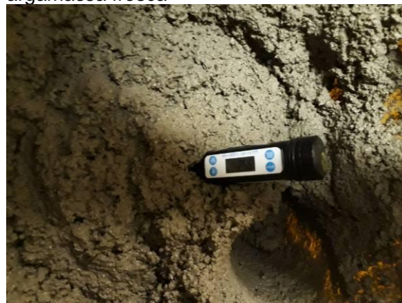
Foto 77 – Determinação da temperatura da argamassa fresca
