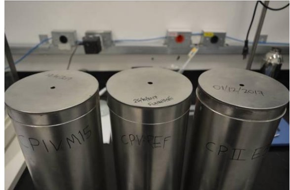
Foto 28 – Detalhe dos moldes metálicos utilizados para realização dos ensaios no HeatBox
