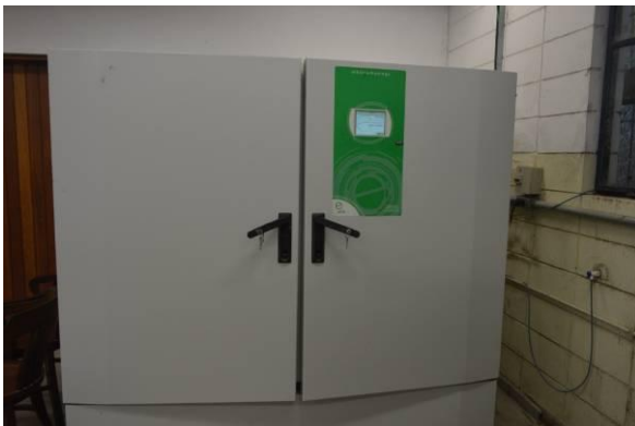
Foto 62 – Estufa climatizada para pré-aquecimento dos materiais utilizados para determinação do tempo de pega para 44°C e 65°C
