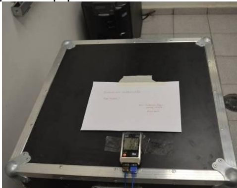
Foto 54 – Ensaio do HeatBox em andamento. Detalhe do Datalogger fixado na tampa do equipamento
