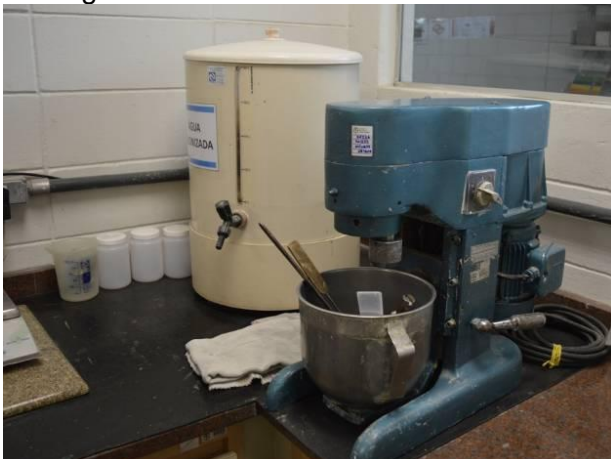
Foto 23 – Equipamento utilizado para mistura das argamassas. Notar o recipiente de água deionizada utilizado para confecção das argamassas
