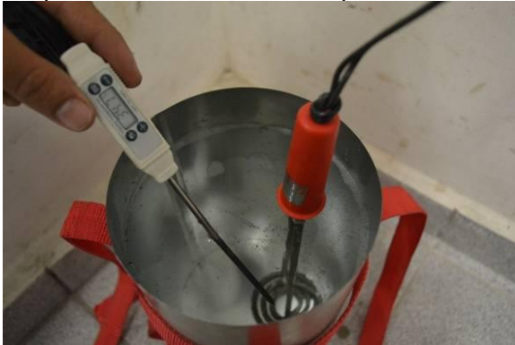
Foto 29 – Aquecimento da água através de resistência térmica e monitoramento da temperatura durante o seu aquecimento
