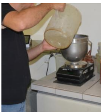
Foto 66 - Determinação da massa de água utilizada para confecção das argamassas
