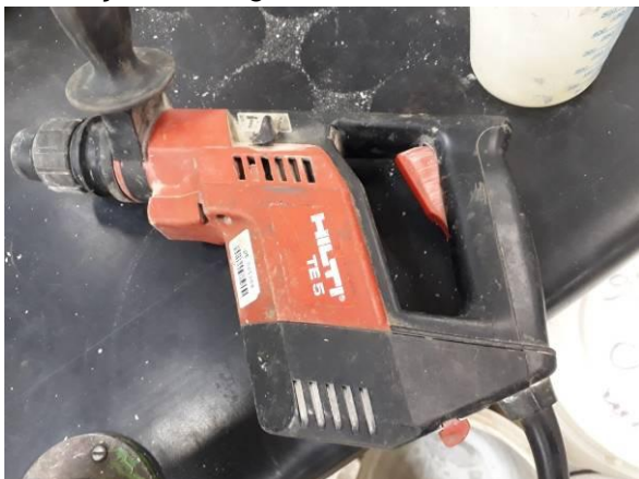
Foto 64 – Misturador utilizado para confecção das argamassas
