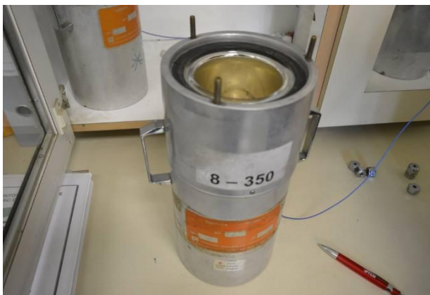
Foto 17 – Detalhe da garrafa para colocação da amostra de argamassa
