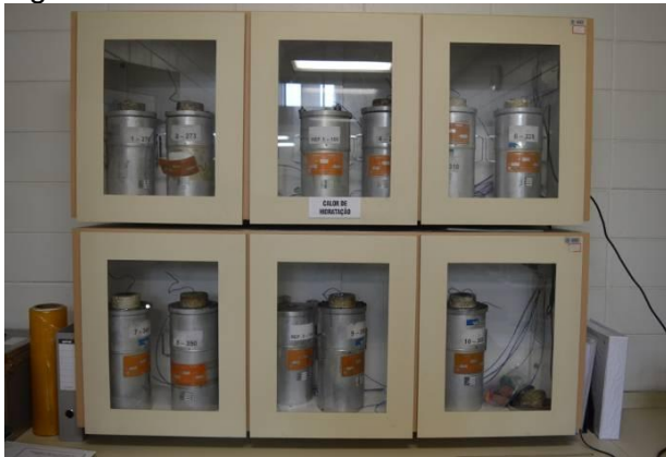
Foto 15 – Conjunto de garrafas de Langavant para realização de determinação do calor de hidratação em argamassas
