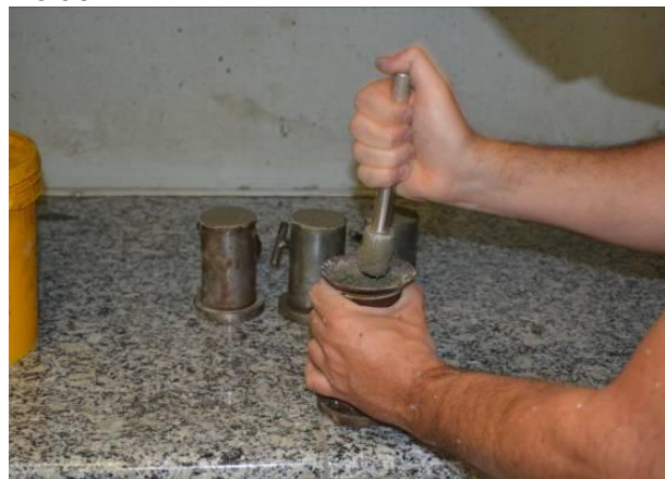
Foto 81 – Adensamento da argamassa no molde
