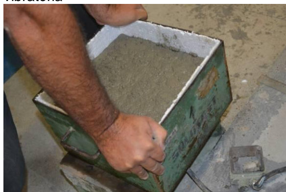
Foto 69 – Adensamento através de mesa vibratória
