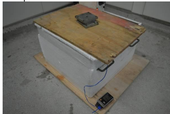
Foto 75 – Fechamento do aparato com isopor e madeira para minimizar a perda de calor para o ambiente
