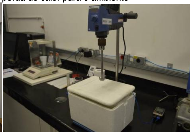
Foto 8 – Isolamento do banho térmico por meio de caixa de isopor para minimizar a perda de calor para o ambiente
