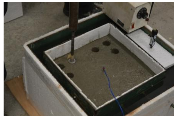
Foto 73 – Determinação do tempo de pega através da penetração pela agulha de Proctor
