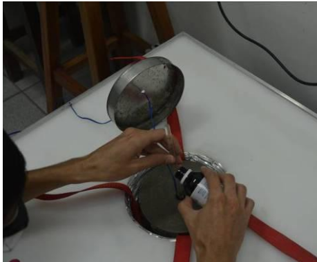
Foto 52 – Utilização de óleo mineral no tubo de ensaio instalado no centro da amostra para favorecer a condução de calor
