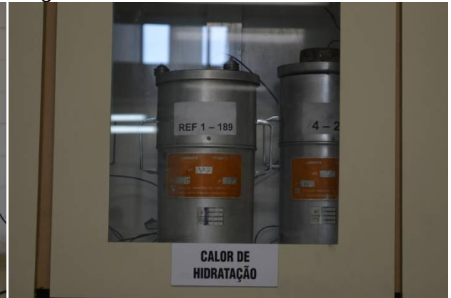
Foto 16 – Garrafa de referência mantida fechada a vácuo - Ensaio de calor de hidratação pelo método da garrafa de Langavant
