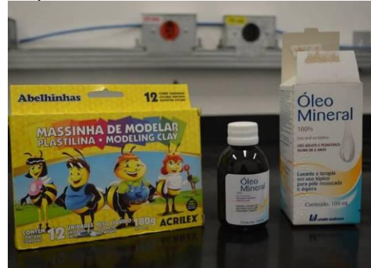
Foto 51 – Massa de modelar utilizada para minimizar a evaporação de água da amostra e óleo mineral utilizado na instalação do termopar
