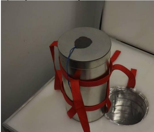
Foto 33 – Fechamento do molde com tampa metálica e vedação através de massa de modelar para minimizar a perda de água por evaporação na realização dos ensaios
