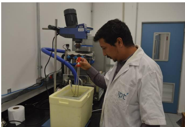
Foto 7 – Aquecimento do banho térmico por meio da utilização de resistência térmica
