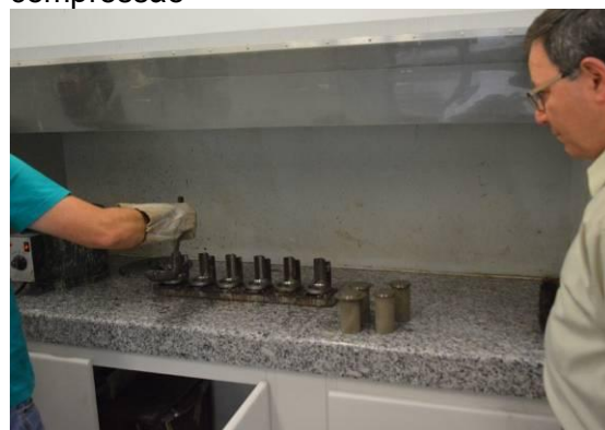
Foto 91 – Capeamento dos corpos-de-prova para nivelamento das suas superfícies previamente aos ensaios de resistência à compressão
