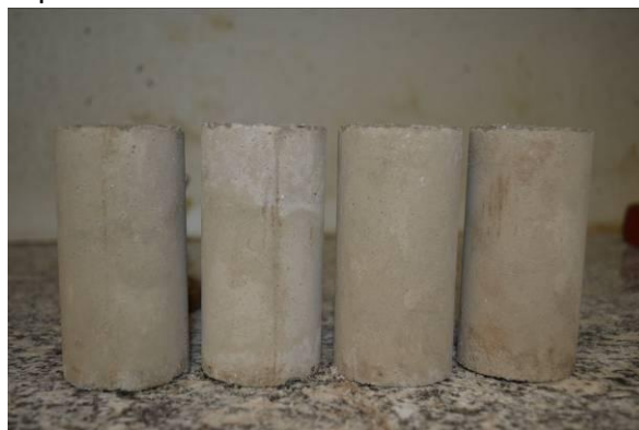
Foto 88 – Detalhe dos corpos-de-prova após retirada da cura e previamente ao seu capeamento com enxofre
