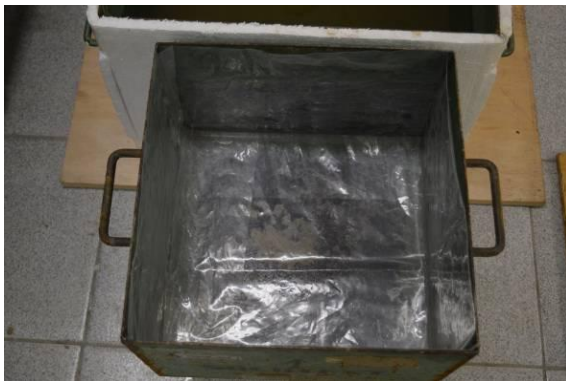
Foto 56 – Molde utilizado para determinação do tempo de pega através da utilização da agulha de Proctor
