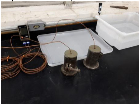
Foto 82 – Instalação de sensores de temperatura para aquisição on line da temperatura durante o período de cura
