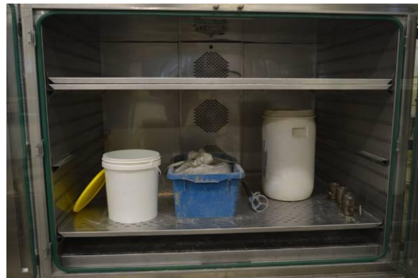
Foto 63 – Acondicionamento dos aparatos e materiais secos em estufa destinados à dosagem e moldagem das argamassas para acondicionamento térmico
