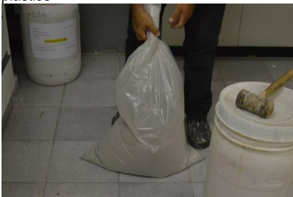
Foto 60 – Mistura manual dos materiais secos para a argamassa em uma de saco plástico
