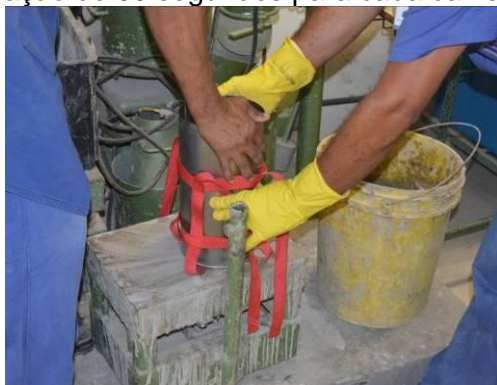
Foto 48 – Adensamento da argamassa em mesa vibratória, em duas etapas com duração de 05 segundos para cada camada
