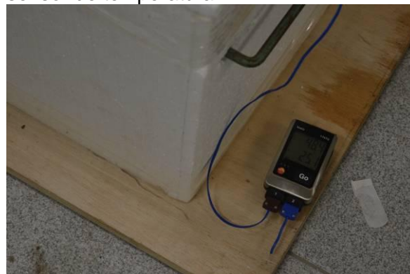
Foto 71 – Monitoramento da temperatura ambiente e temperatura da amostra com sensor de temperatura
