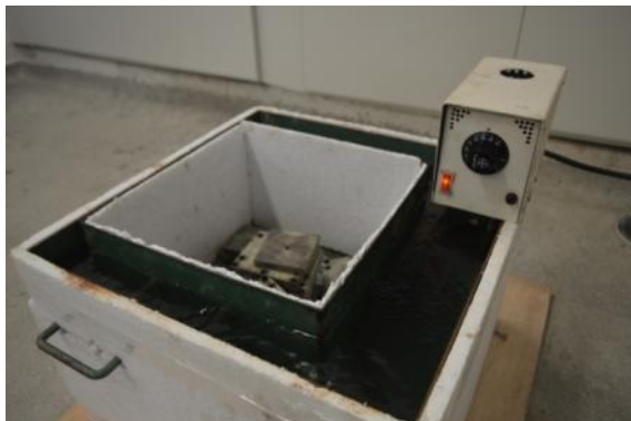
Foto 58 – Instalação de termostato para manutenção da temperatura constante do banho térmico
