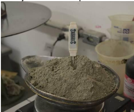
Foto 41 – Pesagem do cimento e de determinação da sua temperatura
