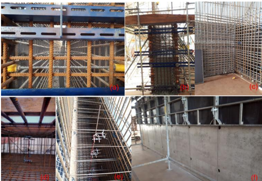
Figura 12 - (a, b) teste de forma com tela de aço expandida, (c) teste de armadura de pele, tela de vidro e tela metálica, (d) instrumentação da placa de piso Tipo B, (e) parede do túnel com extensômetros elétricos de corda vibrante e rosetas, (f) teste de agente desmoldante e aparência do concreto.
